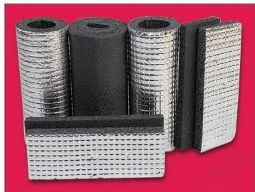
این عایق از طریق ایجاد ساختار سه بعدی که بوسیله پخت صورت می گیرد، بوجود می آید. ضخامت های ۳ تا ۳۵ میلی متر به صورت رول، ۴۰ تا ۱۲۰ میلی متر به صورت تشك و در دانسیته های ۳۰ تا ۲۰۰ تولید می شود. ضخامت های ۱۰ تا ۲۵ میلی متر و در سایز های ۲/۸ تا ۵ اینچ به صورت فوم لوله تولید می شود. عایق های فوق قابلیت لمینه شدن با انواع: فویل های آلومینیوم، متالایز، فیلم های پلیمری، پی وی سی رادارا می باشد.
